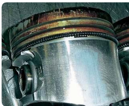
☛ А это – полтора балла высокотемпературных отложений.
