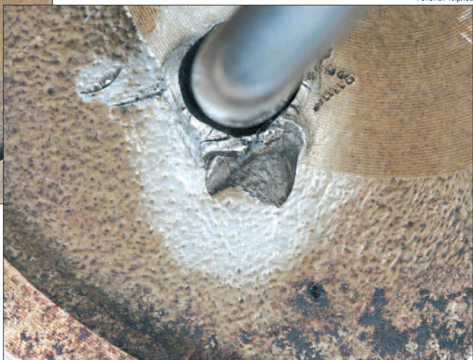
Скорее всего, повреждение стержня — не причина «коллизии», а ее следствие. Интуиция подсказывала, что источник болезни все же кроется в нарушении синхронности работы кривошипно-шатунного и газораспределительного механизмов.
