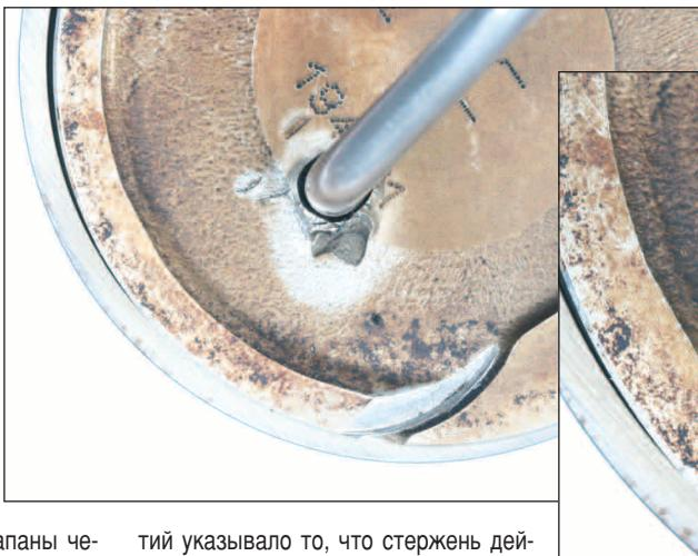
тий указывало то, что стержень действительно разрушен в месте проточки для фиксации сухарей. Известно, что подобные повреждения клапана в большинстве случаев являются следствием одной из следующих причин:
