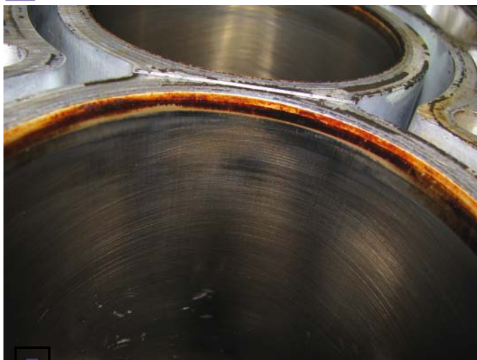
Признак пятый — след от перекошенного поршня в верхней части цилиндра
