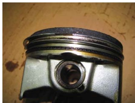
Признак четвертый — следы перекоса поршня в цилиндре
