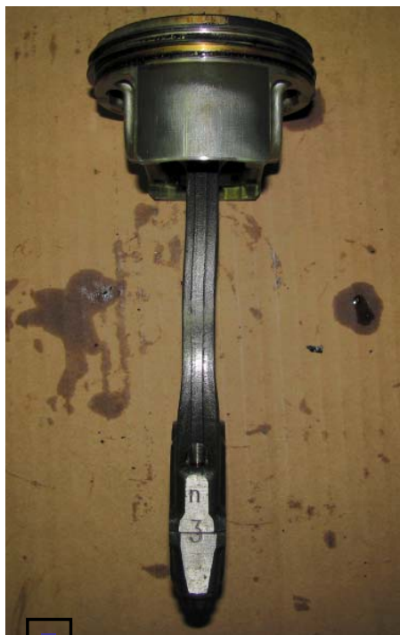
Признак третий — характерная «змейка» на шатуне, потерявшем устойчивость в результате осевого сжатия
