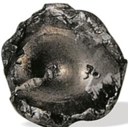
**Поломка клапана от больших механических перегрузок.**
