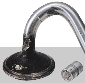
Разрушение по пазу сухаря может случиться из-за неправильной разборки и сборки клапана, а также вследствие больших зазоров в приводе.
