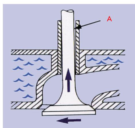
лее характерна для старых, изрядно походивших, моторов. Иногда стук клапана связан с неконцентричностью седла и отверстия направляющей втулки, что является следствием перегрева головки блока или неправильно выполненного ремонта. При этом клапан садится на седло сначала одним краем тарелки, и только затем, перекатываясь во втулке в пределах зазора, полностью. Из-за этого, кстати, износ направляющей втулки быстро прогрессирует.
